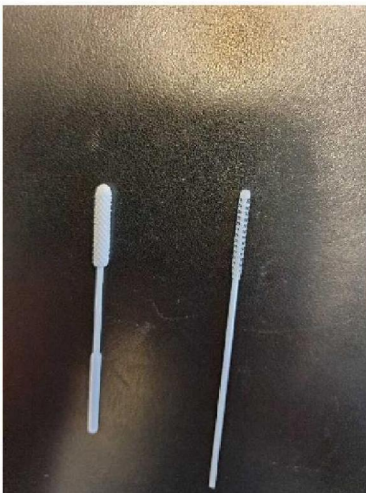
Figuur 2 eerste prototype en huidige gegoten swab, beide in Nederland gemaakt.
