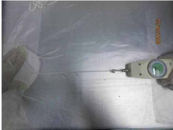
54 loop pull test (6).JPG
