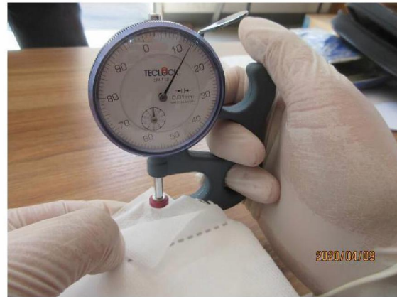
61 thickness check (2).JPG
