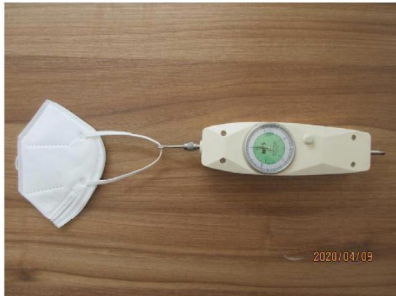
52 loop tension test (1).JPG
