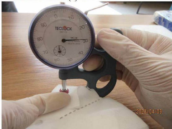
61 thickness check (3).JPG
