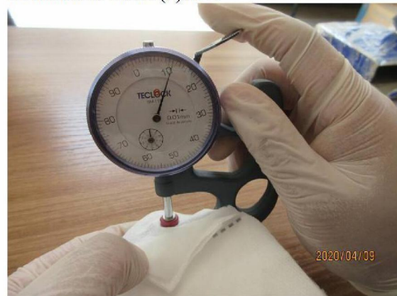
61 thickness check (4).JPG
