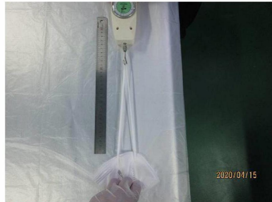
55-loop tension test.JPG
