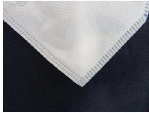
Nahtverschweißung / Seam welding
