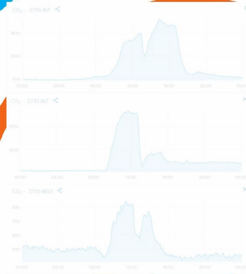
Afbeelding B5.3: Voorbeeld van het verloop van de CO 2 -concentratie met gegevens zoals beschikbaar bij gegevensregistratie van een CO 2 -meter.
